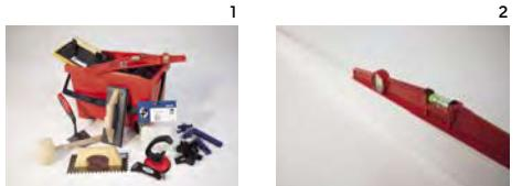
1 La colocación de cerámica requiere de personal cualificado, con experiencia demostrada y herramientas y útiles adecuados: llanas dentadas, crucetas, mazos de goma, ventosas para la colocación y llanas de goma, esponjas y cubetas para el rejuntado. Revisar previamente la información contenida en los embalajes y respetar escrupulosamente las recomendaciones del fabricante.
